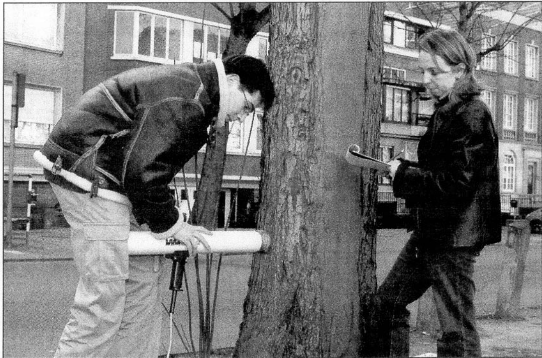
Murielle Eyletters et Benoît Buntinx auscultent les arbres avec le résistographe. Photo Rudolf Marton.
